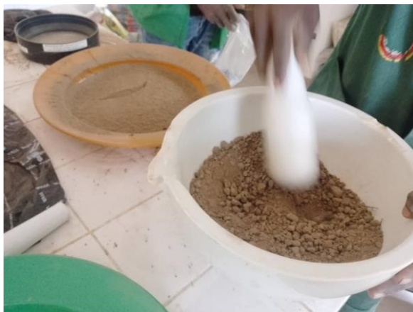
Photos illustrant le broyage et tamisage des échantillons de sol en laboratoire
