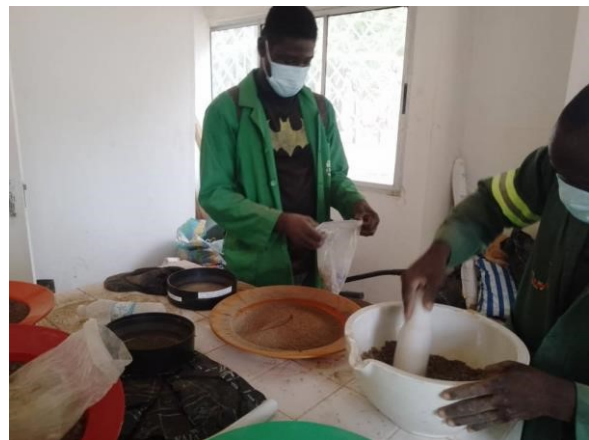
Photos illustrant le broyage et tamisage des échantillons de sol en laboratoire
