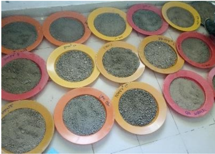
Photo illustrant le séchage à l'ombre des échantillons de sol
