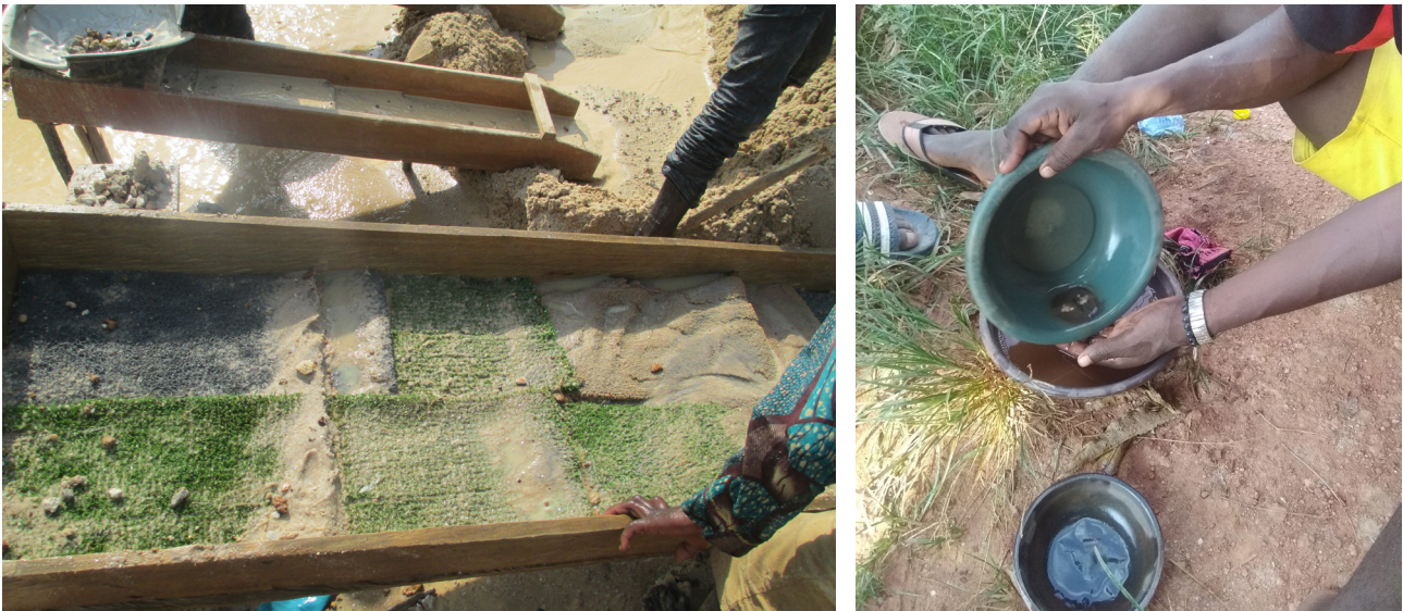
Images3: Les différentes étapes du processus d'exploitation aurifère artisanale : lavage (E) ; amalgamation (F).
